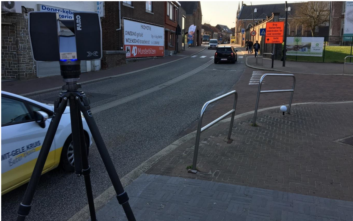
Figuur 12 3D-laserscanner (hier ingezet op een onderzoekslocatie van een ander onderzoek).
